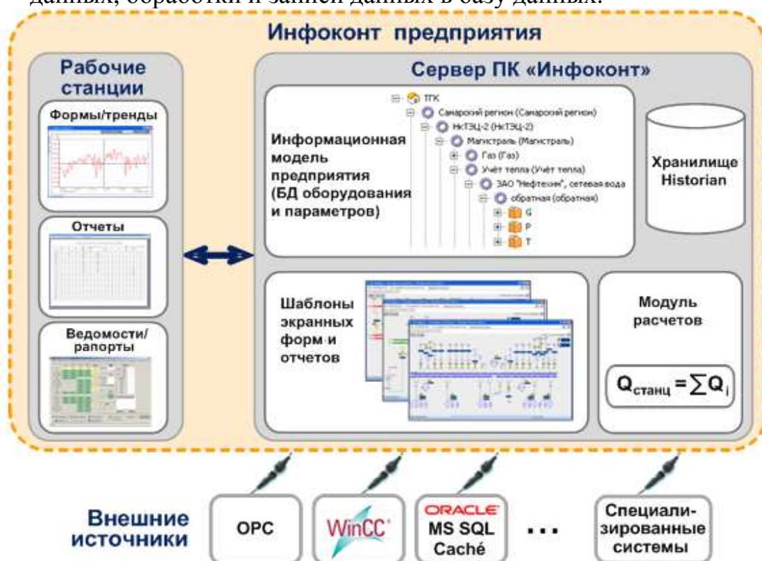
Рис.1. Упрощённая структура информационной среды «Инфоконт»
