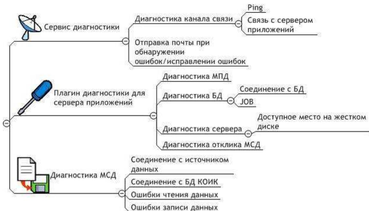
Рис. 2. Структура системы диагностики информационной среды «Инфоконт»
