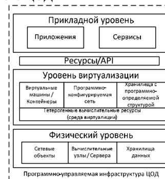
Рис. 1. Уровневая схема программно-управляемой инфраструктуры виртуального ЦОД
