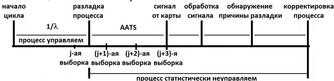
Рис. 1. Схема цикла технологического процесса
