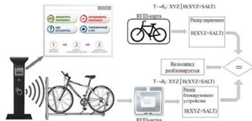
Рисунок 1 – Формализованный протокол оборудования велопаркомата
