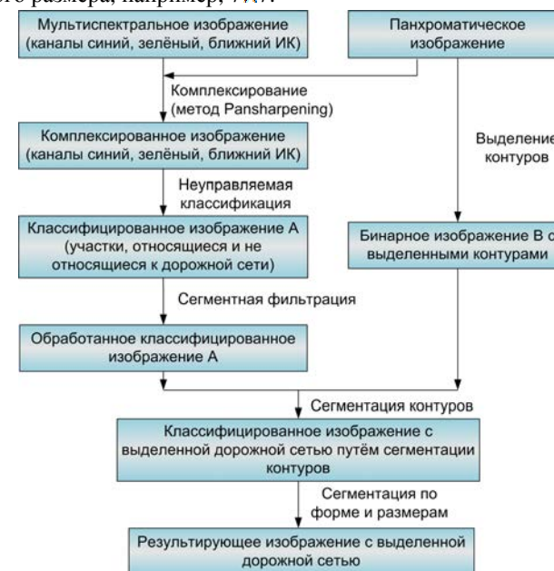
Рисунок 2. Технология автоматизированного распознавания элементов сети автомобильных дорог
