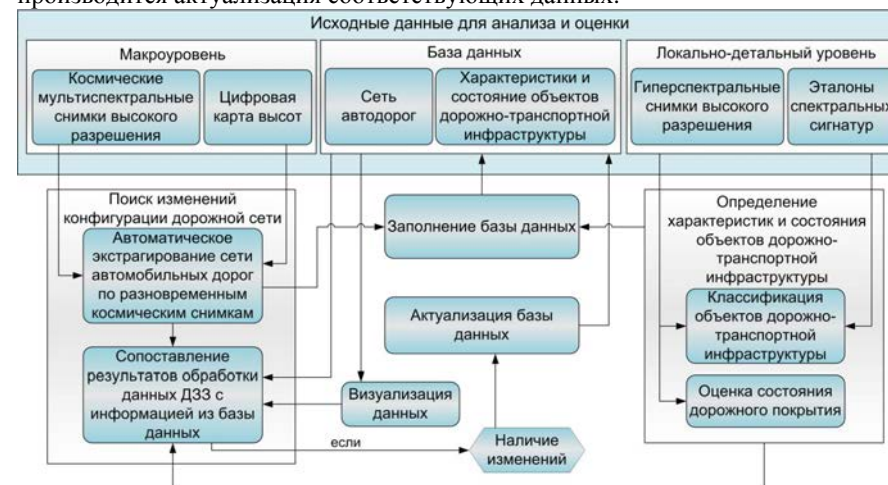
Рисунок 1. Схема поддержки управления состоянием объектов транспортной инфраструктуры на основе информации дистанционного зондирования Земли
