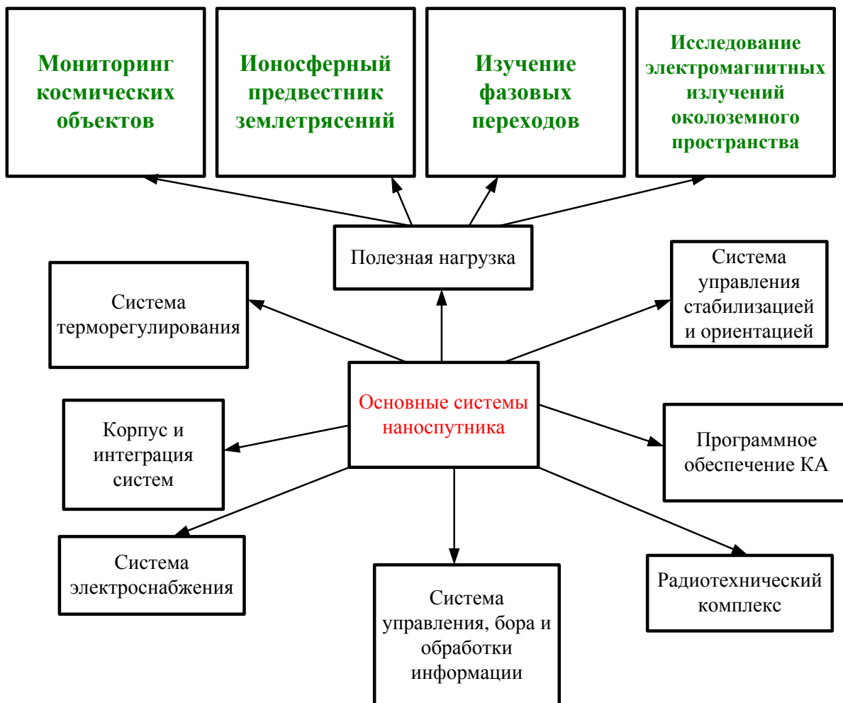
Рис. 1 – Основные системы и научные задачи, решаемые наноспутником
