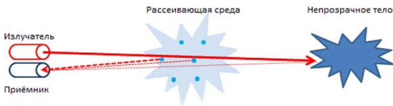
Рисунок 5.3 – Схема времяпролетного метода измерения расстояния
