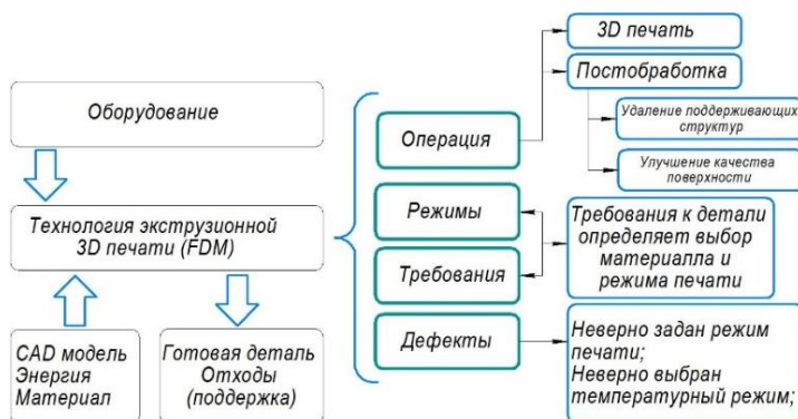
Рисунок 1.2 – Схема технологического процесса FDM печати
