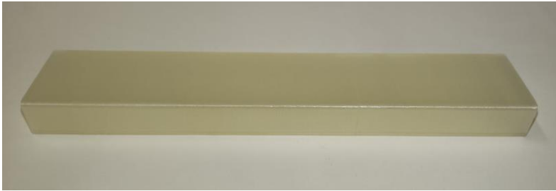
Рисунок 4.3 – Канал, соединяющий стояки, без перехода в питатель
