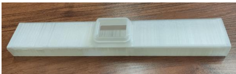
Рисунок 4.2 – Канал, соединяющий стояки, с переходом в питатель
