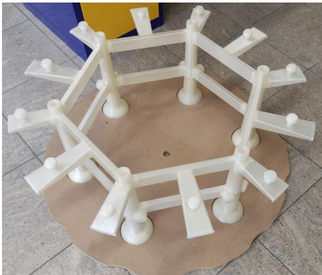
Рисунок 4.10 – Предварительная сборка элементов ЛПС в единую конструкцию
