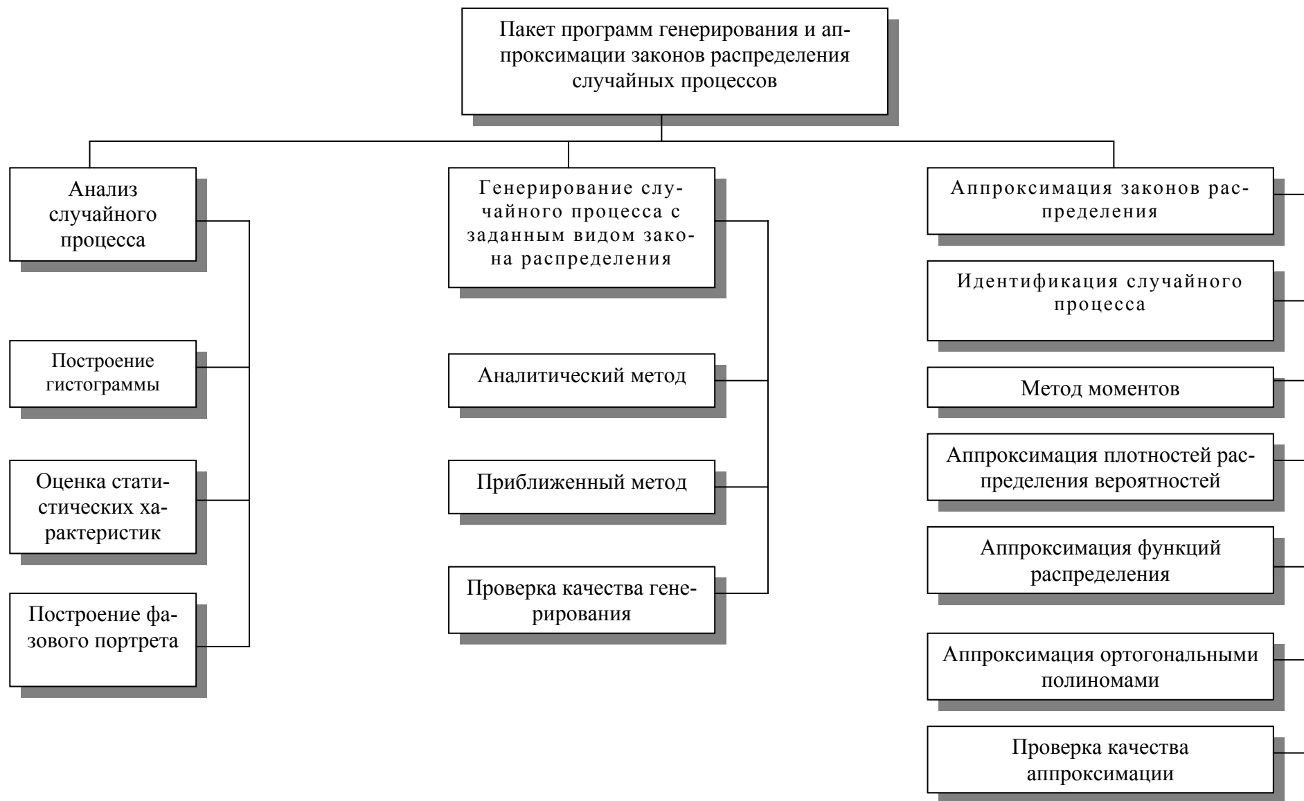
Рисунок 5.129 - Пакет программ генерирования и аппроксимации законов распределения случайных процессов
