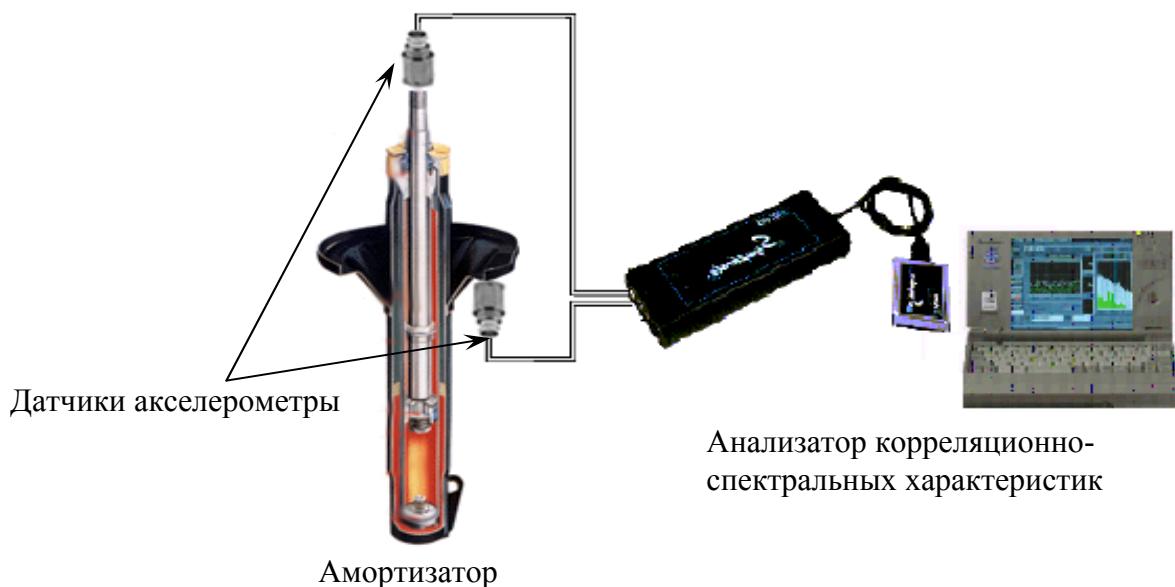
Рисунок 8.14 – Структура измерительной системы
