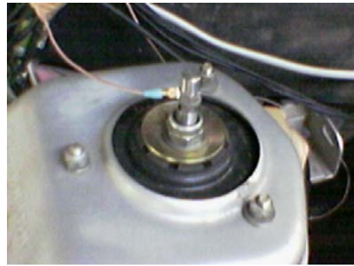
б) Крепление на штоке амортизатора
