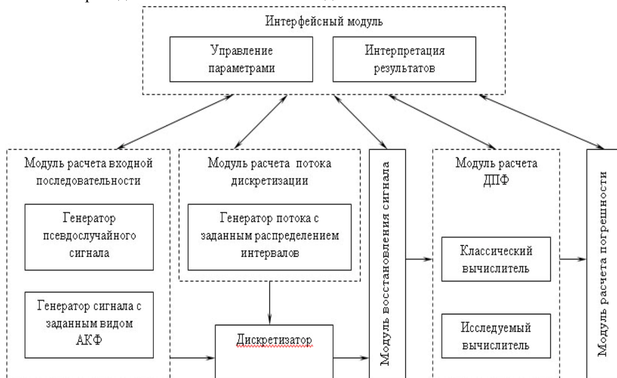
Рисунок 5.183 - Структура системы имитационного моделирования
