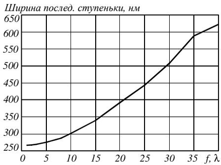
Рис. 1.33 Зависимость ширины последней ступеньки зонной пластинки с радиусом  $R=20\lambda$  от фокусного расстояния  $f$
