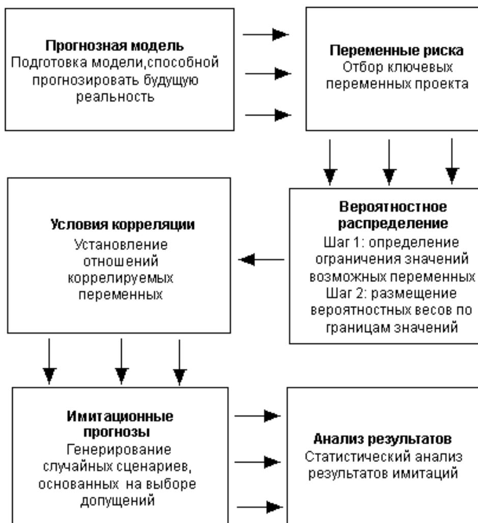
Рисунок 4.11. Алгоритм формирования имитационной модели для анализа риска
