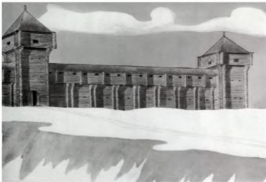
Стена, рубленая городнями. Реконструкция. Из кн.: Крадин Н.П. Русское деревянное оборонное зодчество. М., 1988
