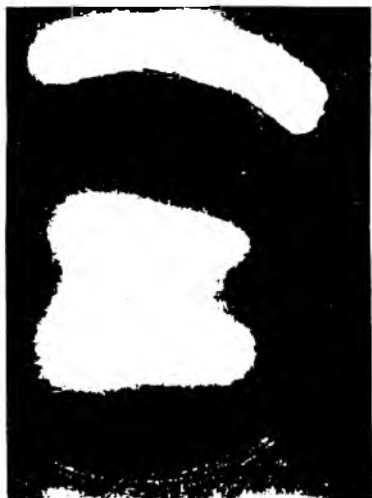
Р и с. 3.6. Одновременное горение скользящего и основного разрядов в остаточной воздушной среде при p \approx 30 кПа, C_H = 2 нФ, C_{об} = 30 пФ, U_{зар} = 30 кВ
