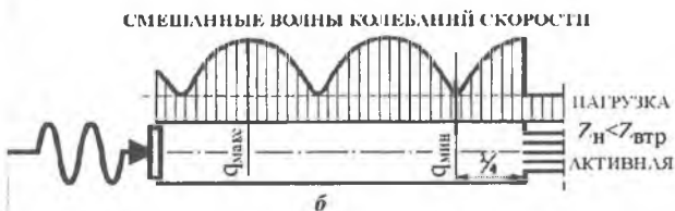
Рис. 2.17. Распределение амплитуд колебаний давления и амплитуд колебаний объемной скорости вдоль трубопровода, нагруженного на активную нагрузку, величина которой меньше волнового сопротивления трубопровода
