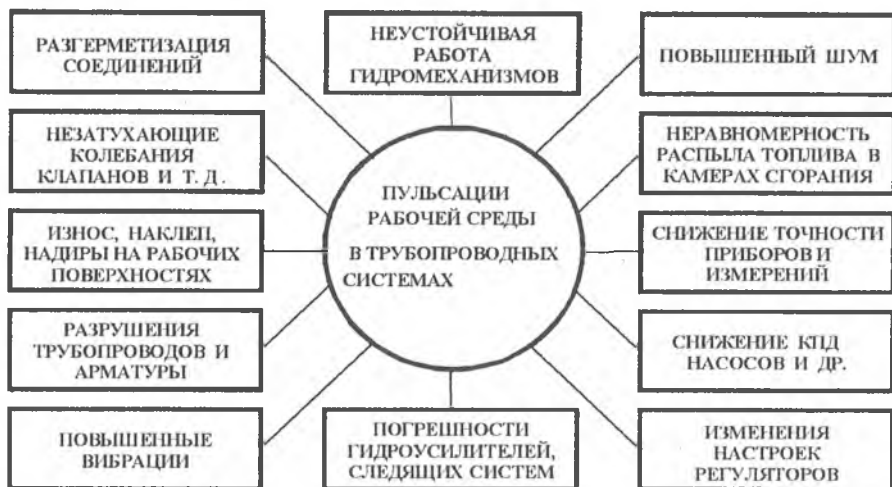
Рис. 1. Влияние пульсаций на функционирование технических объектов
