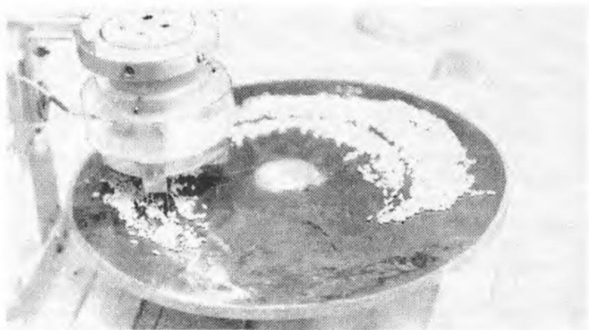
Рис. 4.10. Лабораторная модель установки для обработки семян на дисковом подвижном электроде в пульсирующем газовом разряде
