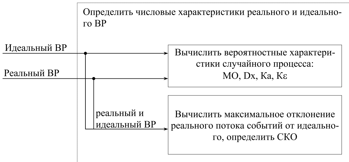
Рисунок 7.4. Структурная схема блока определения числовых характеристик ВР
