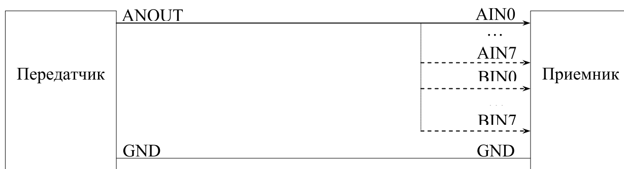
Рисунок 7.9. Схема соединения АС в 1-ом режиме
