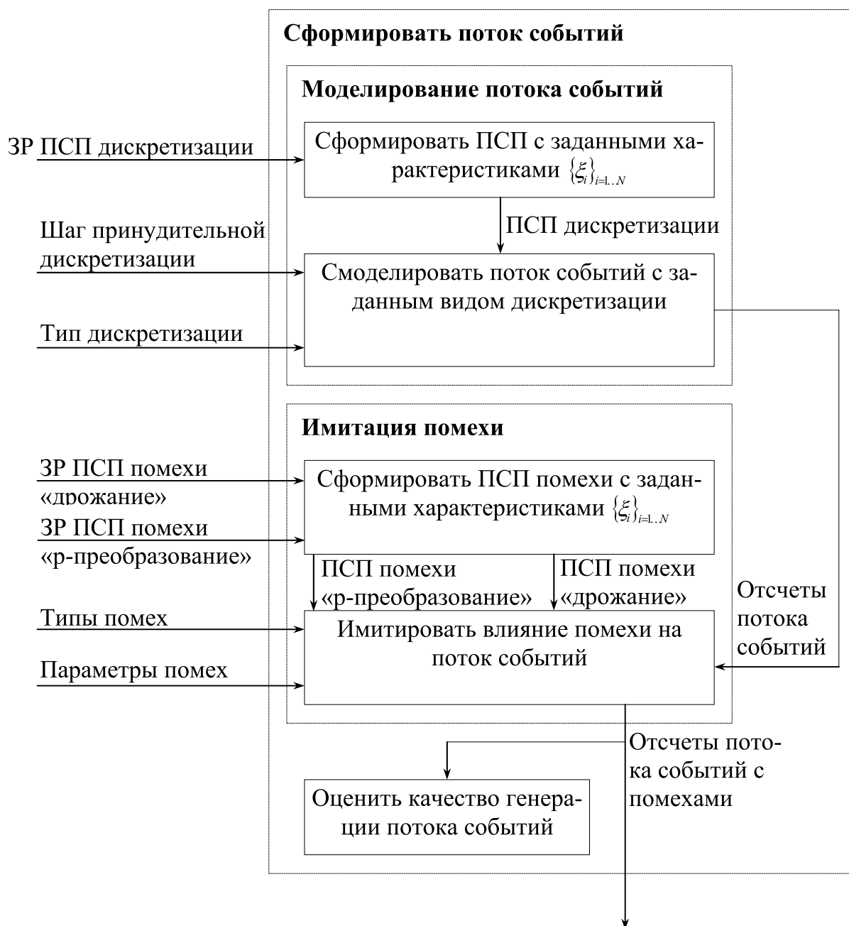
Рисунок 7.3. Структурная схема блока формирования потока событий
