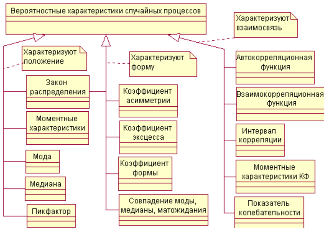
Рисунок В.1. Классификация вероятностных характеристик случайных процессов
