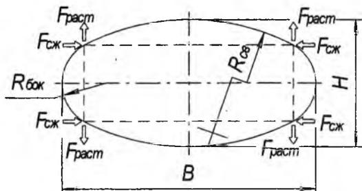
Постановка продольных стенок в местах сопряжения дуг окружностей (на рисунке показаны пунктирными линиями) позволяет обеспечить безмоментную работу конструкции. При этом в вертикальных стенках возникают растягивающие усилия, а в горизонтальных - сжимающие.
