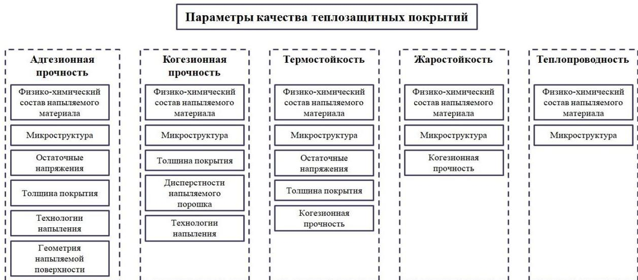
Рис. Параметры качества теплозащитных покрытий, нанесенных методом газотермического плазменного напыления
