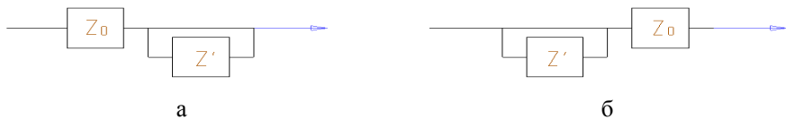
Рис. 6. Сложенные структуры коробок скоростей (дополнительная структура расположена: а – после основной; б – до основной)
