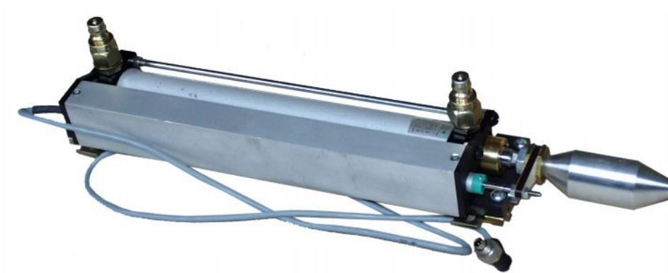
Рис. 5 Потенциометрический датчик перемещения
