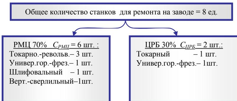
Рис. 6 Пример распределения оборудования между РМЦ и ЦРБ
