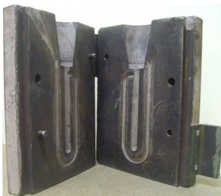
Рисунок 36 – Внешний вид кокиля для получения пробы на жидкотекучесть Нехендзи-Купцова
