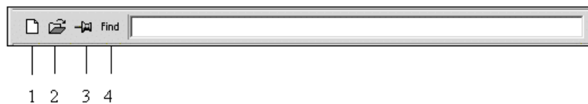
Рис.2.4. Панель инструментов обозревателя разделов библиотек: 1 – создать новую S-модель, 2 – открыть одну из существующих S-моделей, 3 – изменить свойства окна обозревателя, 4 – поиск блока по названию
