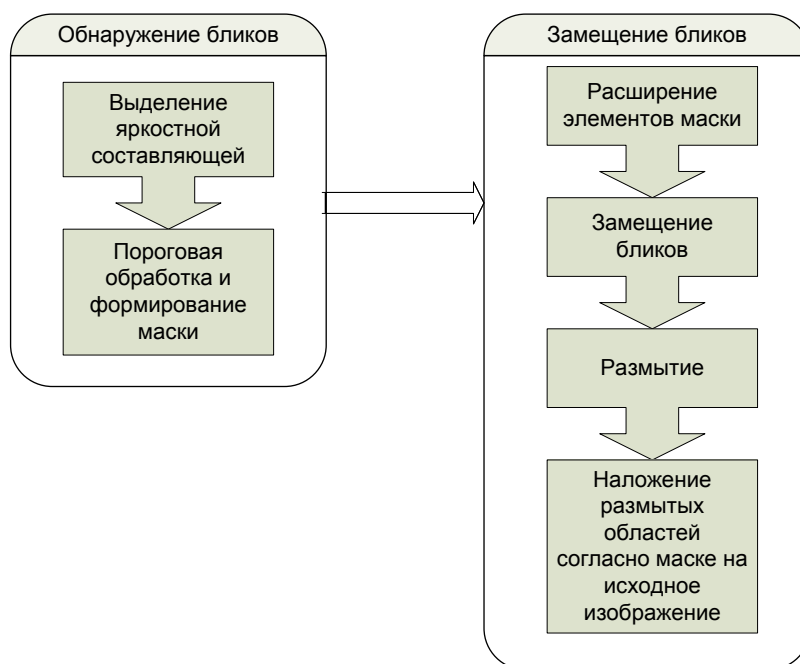
Рисунок 4 – Схема алгоритма цифровой ретуши точечных артефактов
