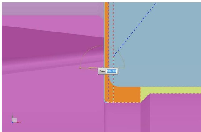
Рис. 35. Генерация подрезки канавки.
