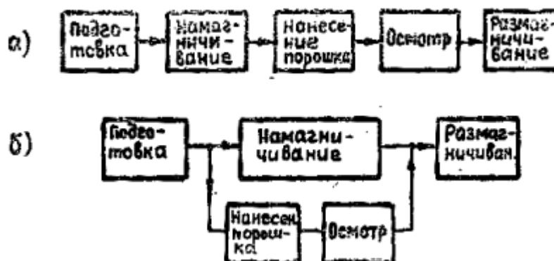
Рисунок 5 - Последовательность операций магнитопорошкового контроля по СОН (а) и СПП (б)
