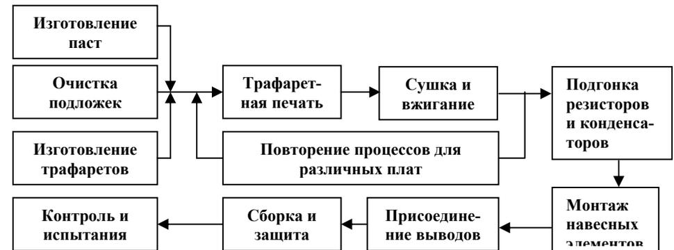
Рис. 1. Общая схема техпроцесса изготовления толстоплёночных интегральных микросхем
