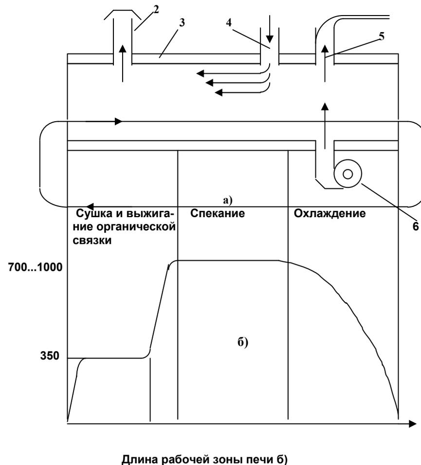
Рис. 4. Схема конвейерной печи термообработки паст (а) и график распределения температуры вдоль печи (б): 1 - конвейерная лента; 2 - вентиляционная система; 3 - кварцевый муфель печи (рабочие зоны); 4 –продувка сухим воздухом; 5 - воздушная завеса; 6 - вентилятор
