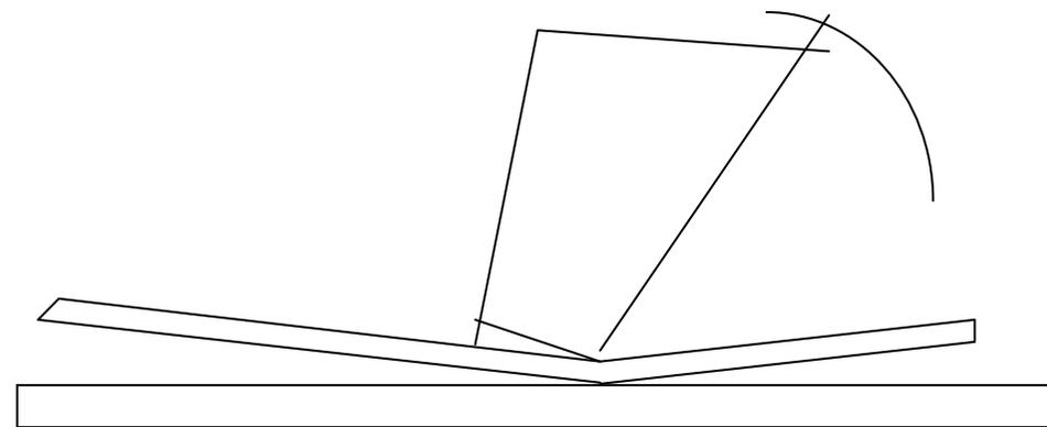
Рис. 2. Схема печати: 1 – паста на поверхности подложки, 2 – ракель; 3 – паста; 4 – трафарет с окнами; 5 – подложка
