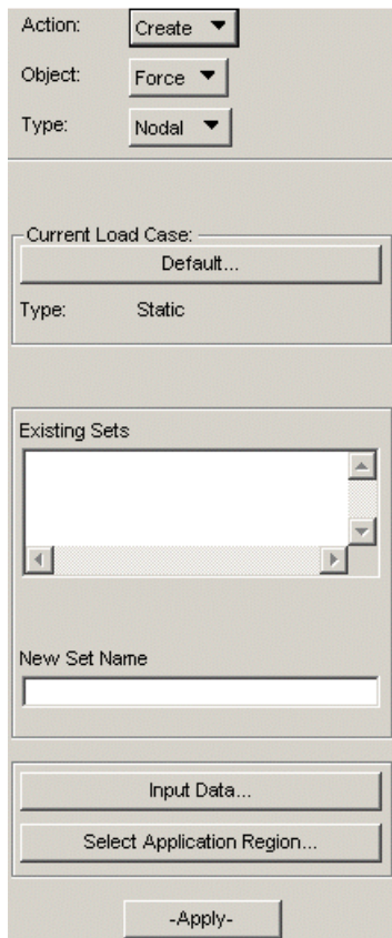
Рис. 2.1.19. Окно команды Create>Force>Nodal задания нагрузок в приложении Loads/BCs
