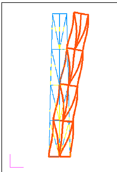
Рис. 2.3.16. Деформации фермы под нагрузками
