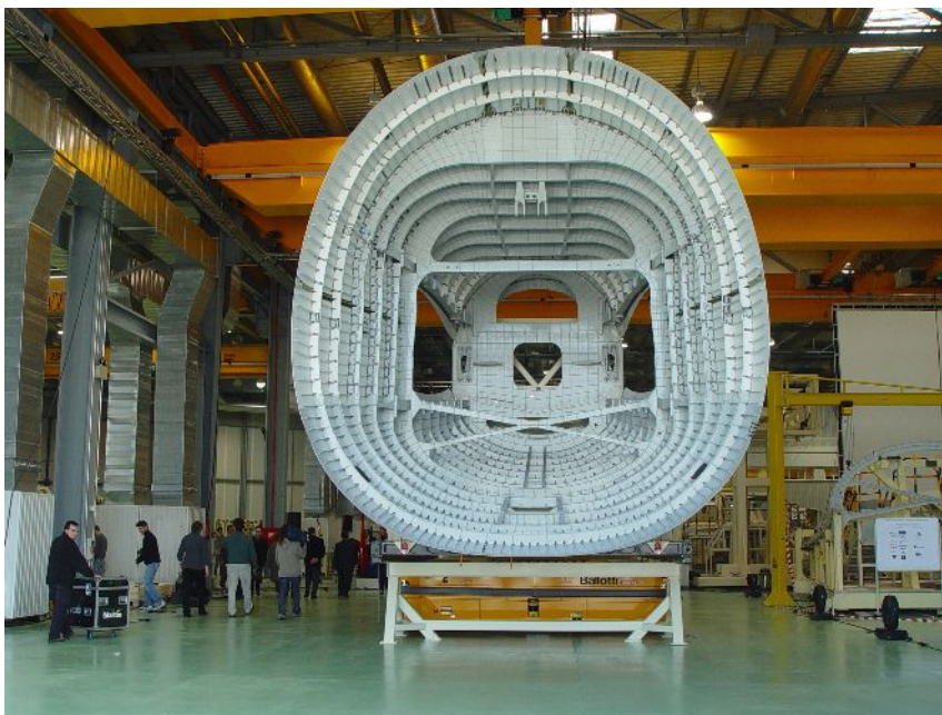
Рисунок 1. Хвостовая часть фюзеляжа А-380
