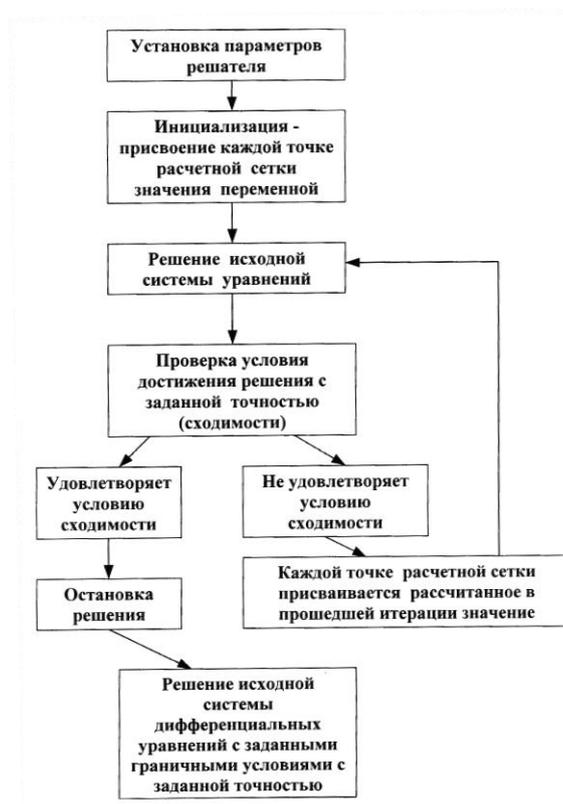
Рис. 11.6. Алгоритм решения уравнений газовой динамики численными методами
