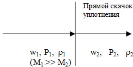
Рис.4.2 Схема течения в прямом скачке уплотнения
