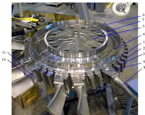
Рисунок 12 – Диск с пазами «ёлочкиного» типа для установки рабочих лопаток
