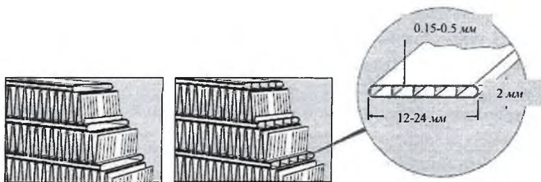
Рис. 7. Параметры трубчато-ленточного теплообменника
