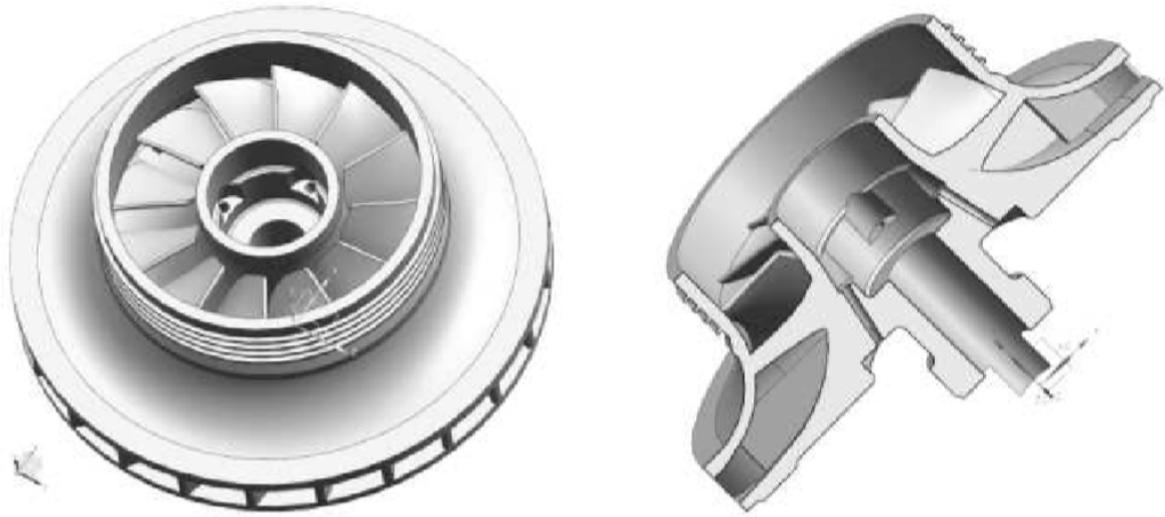
Рис. 8.5. Внешний вид рабочего колеса центробежной турбины
