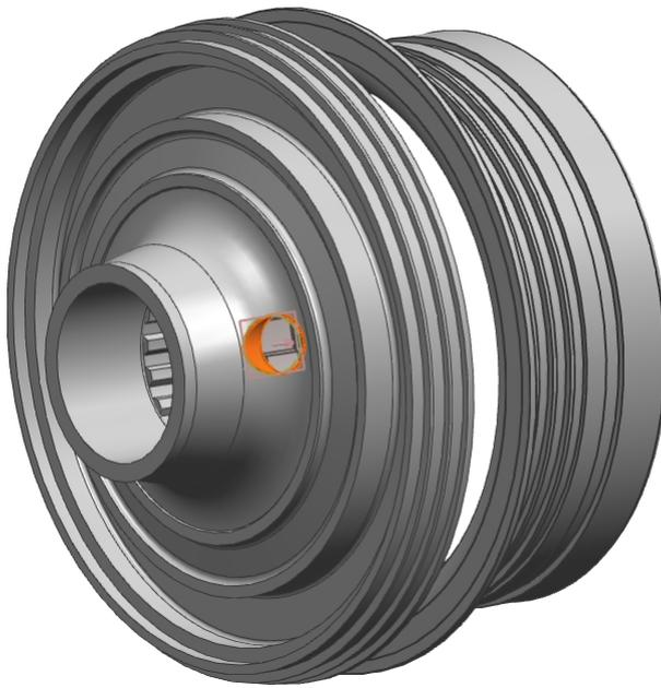
Рис. 4.20. Создание отверстия в диске операцией вытягивания 📏
