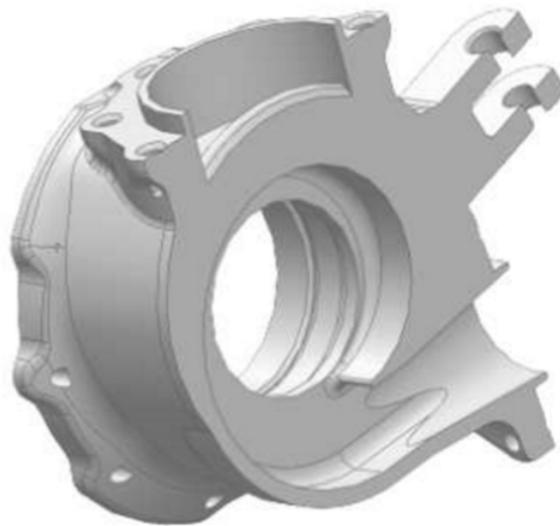
Рис. 12.9. Внешний вид отвода насоса со спиральным сборником
