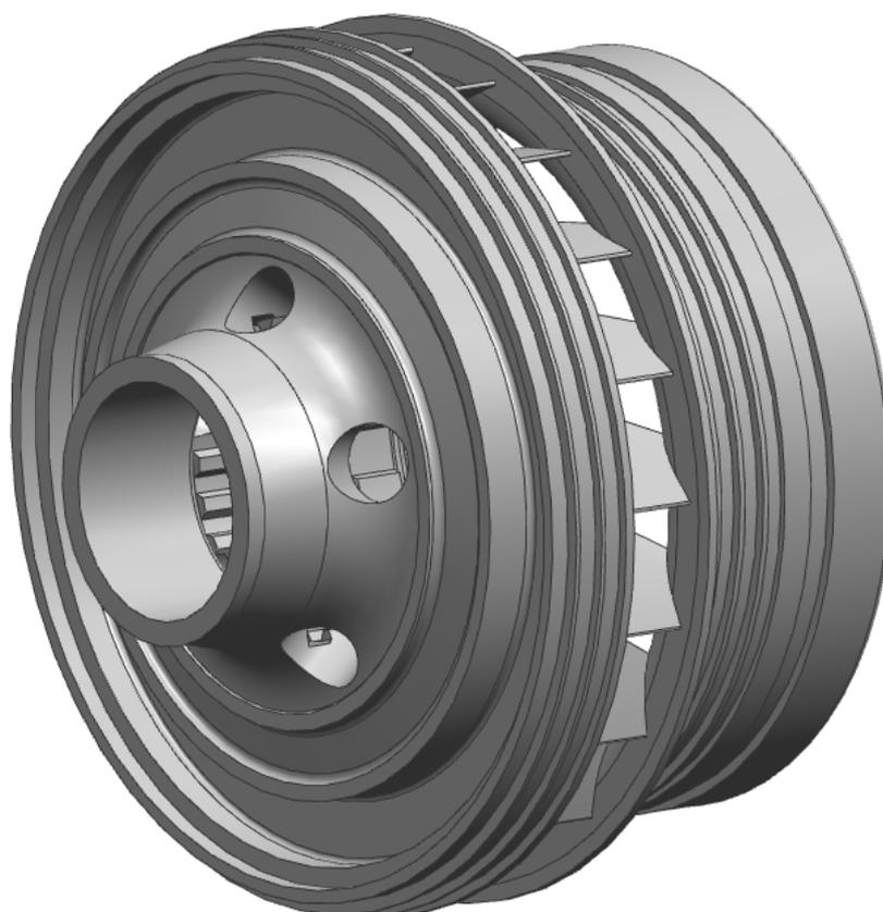
Рис. 4.17. Объёмная модель "Рабочее колесо турбины насоса горючего" ТНА
