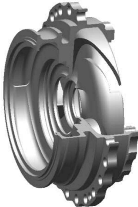
Рис. 12.12. Внешний вид обратного направляющего аппарата
