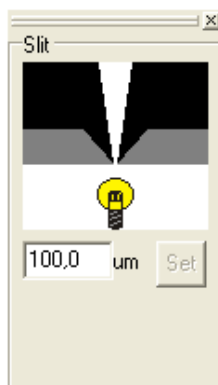
Рисунок 17 – Панель настройки ширины входной щели.
