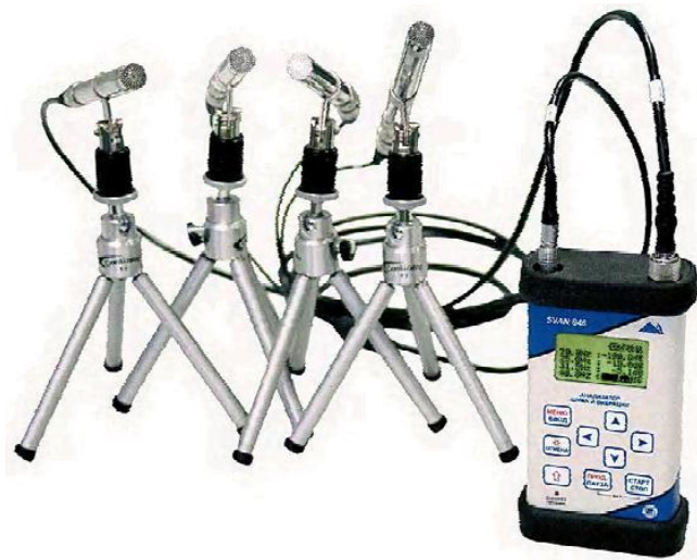
Рисунок 2.2– Внешний вид шумомера Svan 948 с четырьмя микрофонами
