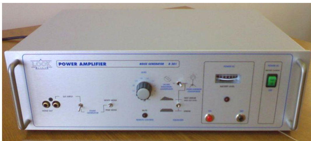
Рисунок 2.4 – Внешний вид генератора белого и розового шума с усилителем мощности
