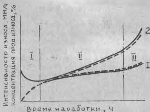
Рис. 4. Изменение концентрации продуктов износа (пунктирная линия) и интенсивности износа (сплошная линия); 1 — масло с удовлетворительными эксплуатационными свойствами (ЭС); 2 — масло с ухудшенными ЭС; I — приработка; II — нормальная работа; III — интенсивный износ, обусловленный разрушением элементов двигателя
