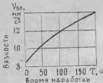
Рис. 2. Изменение вязкости масла МК-8 в процессе его работы в ТРД
