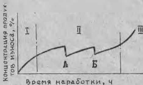
Рис. 5. Изменение концентрации продуктов износа в масле с ухудшенными эксплуатационными свойствами при доле свежего масла (точки А и Б)
