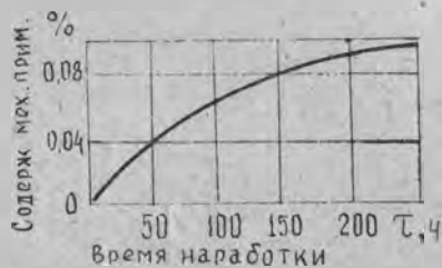
Рис. 3. Изменение содержания механических примесей в масле в процессе работы двигателя
