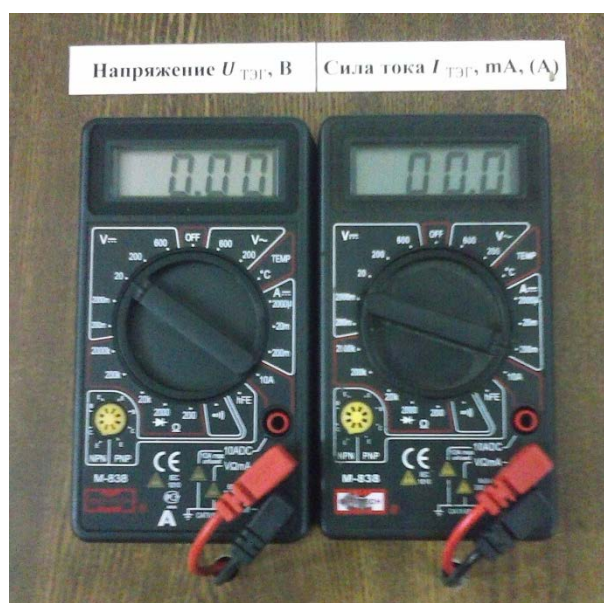
Рисунок 5.3 – Положение переключателей для замера вольтамперной характеристики ТЭГ
