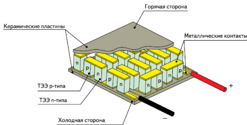
Рисунок 1.1—Термоэлектрический генератор
