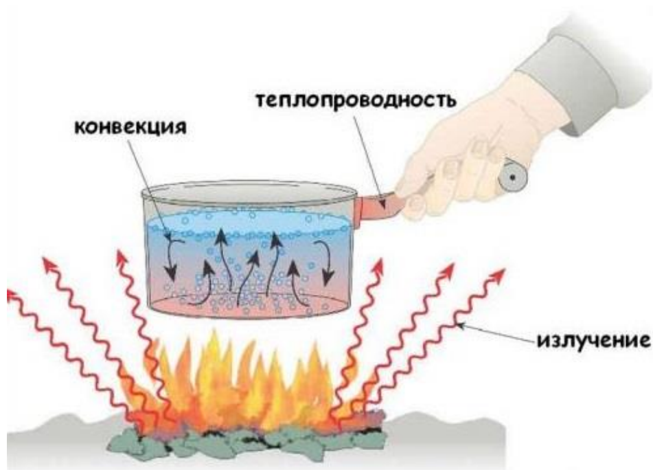
Рисунок 1 – Механизмы передачи тепла
