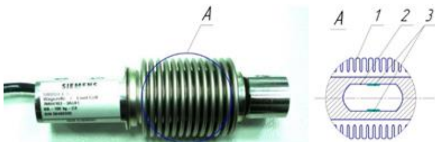
1 – сиффон; 2 – деформированная поверхность; 3 – тензодатчики
