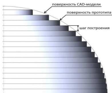
Рисунок 13 – Послойный принцип построения модели на 3D принтере Objet Eden 350
