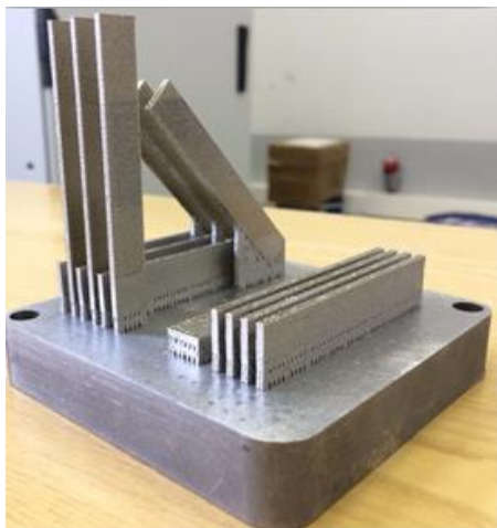
Рисунок 5 - Изготовленные пластинчатые образцы под разными углами выращивания
