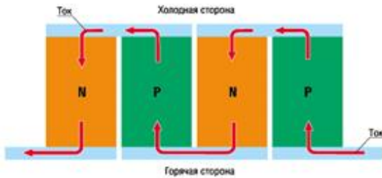
Рис. 2.8 – Использование полупроводниковых структур в термоэлектрических модулях
