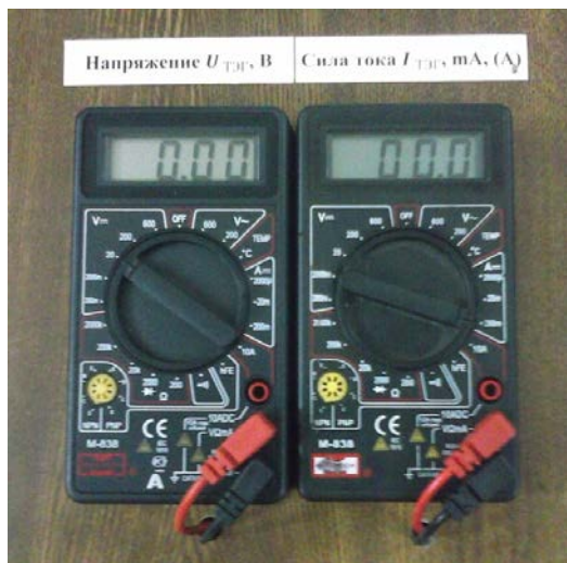
Рис. 8.3 – Положение переключателей для замера вольтамперной характеристики ТЭГ
