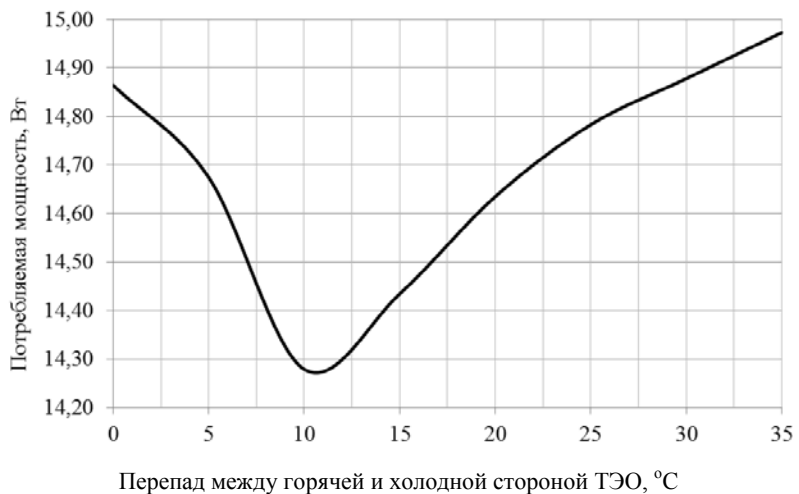
Рис. ПЗ – Зависимость мощности, потребляемой элементом Пельтье, от разницы температур между его горячей и холодной сторонами при напряжении питания 12 В
