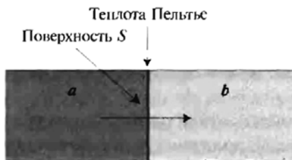
Рис. 2.9 – Перенос тепла посредством электрического тока
