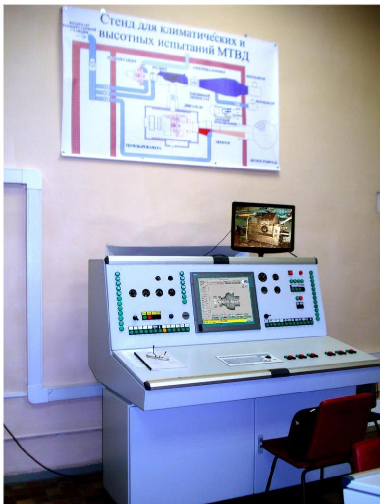
Рисунок 7 – Пульта управления стандом для испытаний ТВД
