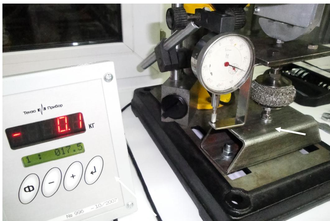
Рисунок 6. - Лабораторная установка с собранной оснасткой для анализа элемента "колокольчик"
