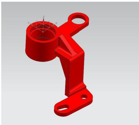
Рис. 4. 3D-модель детали «Качалка»
