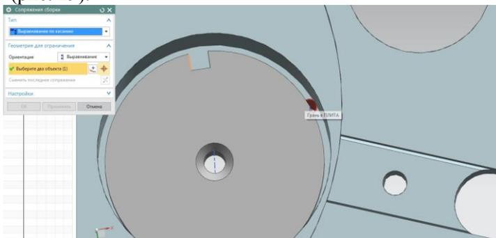
Рис. 26. Ограничение вращения детали вдоль оси Z
