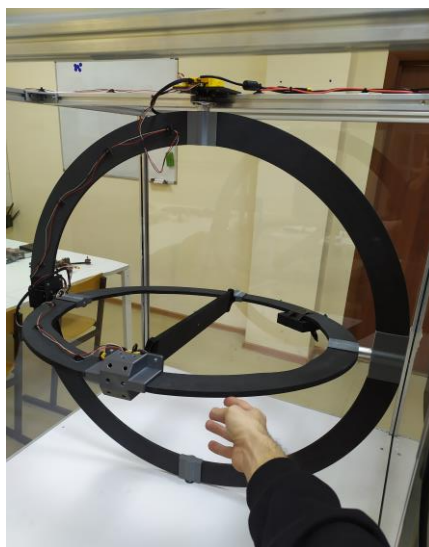
Рисунок 10 – Ручное выведение осей в околонулевое положение при отключенном электропитании станда
