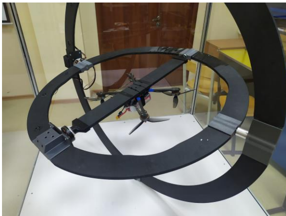
Рисунок 7 – Пример монтажа БПЛА на люльку, вид снизу
