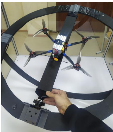
Рисунок 8 – Пример монтажа БПЛА на люльку, вид сверху
