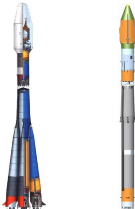
Рисунок 2 – РН Союз 2.1а (слева) и РН Союз 2.1в (справа)
