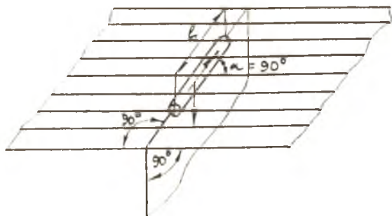
Рис. 1.4. Прямой проводник с током в магнитном поле: направления тока и вектора магнитной индукции взаимно перпендикулярны
