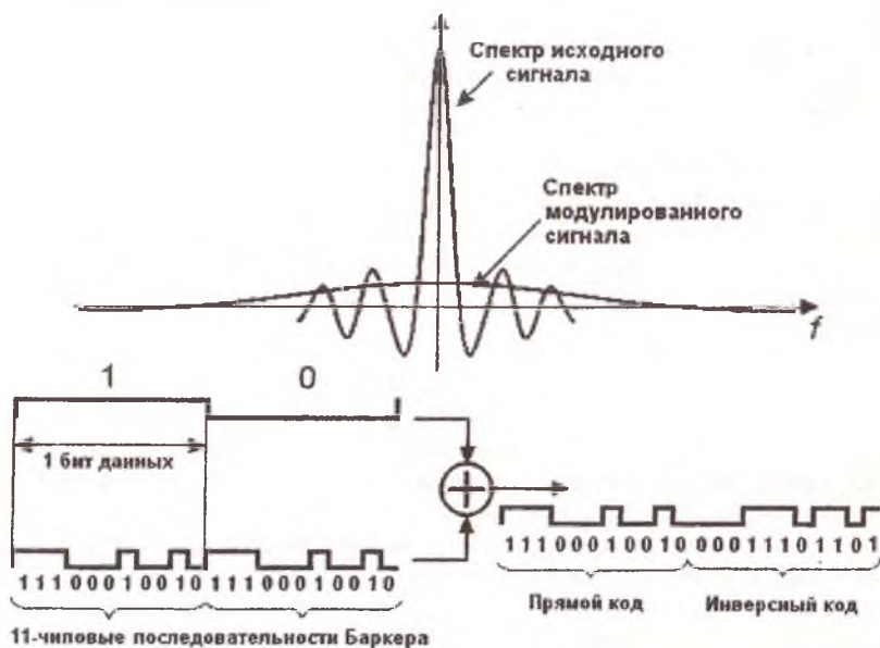
Рис. 11. Изменение спектра сигнала при добавлении шумоподобного кода
