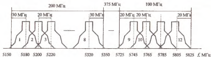
Рис. 18. Разделение диапазона UNII на 12 частотных поддиапазонов (каналов)
