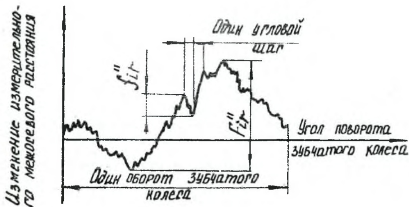
Рис. 9. Изменение измерительного межосевого расстояния по углу поворота колеса: f''_{ir} — колебание измерительного межосевого расстояния за один оборот зубчатого колеса, f''_{ir} — на одном зубе.
