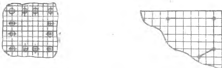
Р и с. 7. Расположение отверстий под неформуемые выводы многовыводных элементов
